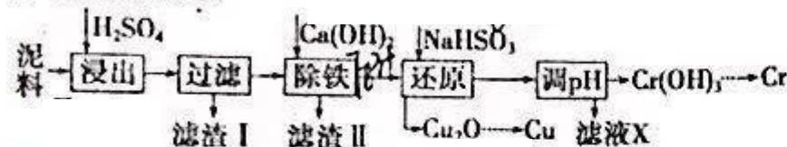
已知部分物质沉淀的pH及 $\text{CaSO}_4$ 的溶解度曲线如下:
